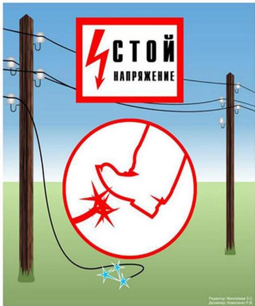
При соприкосновении с оборванными или провисшими проводами, или даже при приближении к лежащему на земле проводу, человек попадает под действие электрического тока и может быть поражен им. Провод-человек-земля-это путь по которому пройдет электрический ток.
