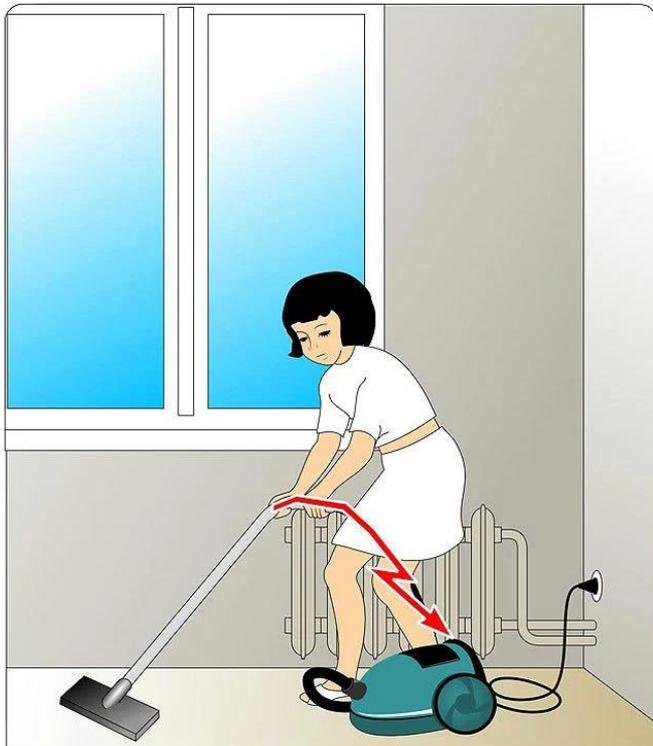
При повреждении изоляции электрического прибора тело человека, прикоснувшегося к металлическим конструкциям в квартире (батареям отопления, водопроводным трубам и другим заземленным конструкциям) или другим электрическим проводникам оказывается в цепи прохождения электрического тока.
